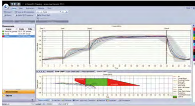
temp-gard 炉温跟踪仪在生产烘道内收集温度数据。
