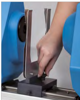
适用于薄膜和片材的样品支架，精确的导轨易于更换各种不同的样品支架(4788)
