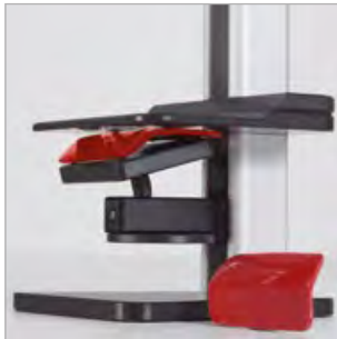
有弹性的样品台，测量车灯清洁剂外罩类部件
